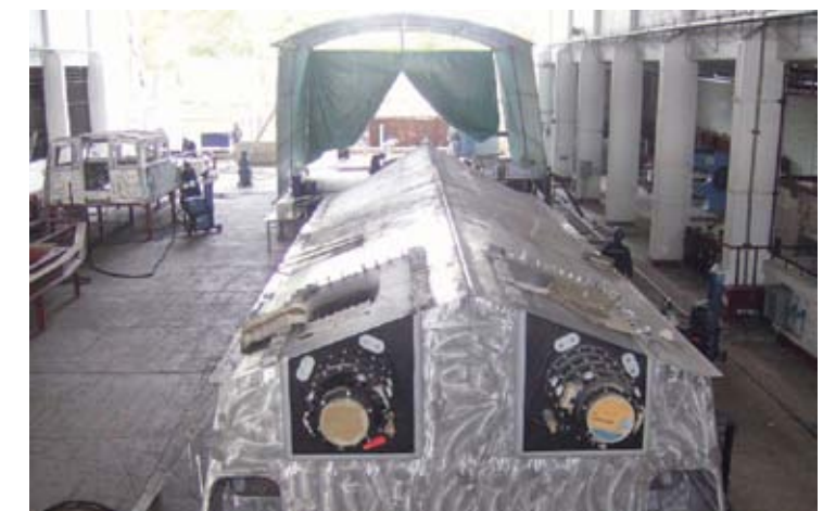
Proceso de construcción de las patrullas interceptoras clase Polaris II en astilleros de la Armada de México
