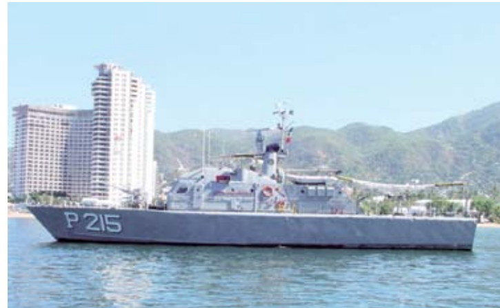
PC-215 ARM "Lizardi" es una patrullera costera de la clase Azteca, de las que once fueron construidas bajo licencia en astilleros de la armada de México
