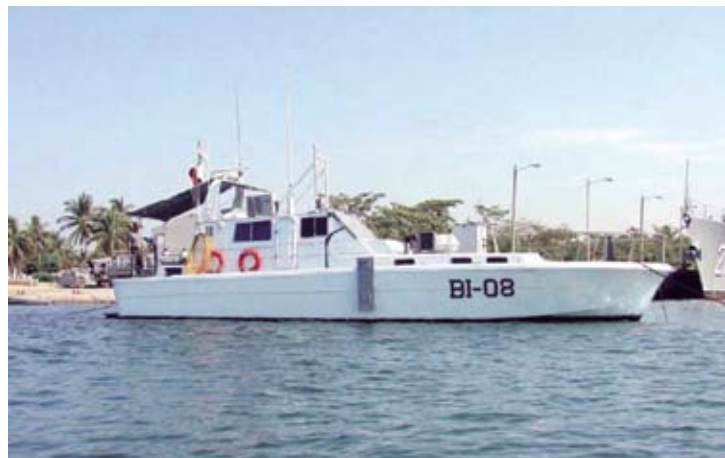
La BI08 ARM "Alacrán" es una lancha de investigación de la clase Olmeca, construida entre 1979 y 1984; desplaza 18 toneladas
